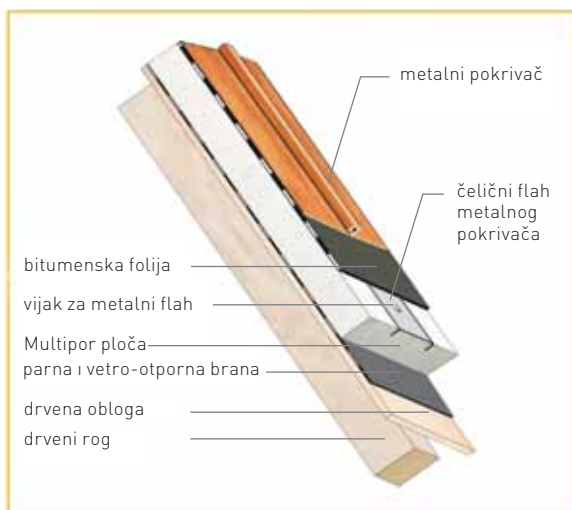
Sistem Multipor termoizolacije sa metalnim krovnim pokrivačem na drvenim konstrukcijama
